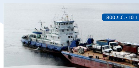
Буксир-толкач, тип ОТА-800 • Лед. класс (Лед 20)
